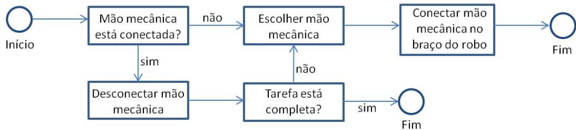
Figure 1.1. Processo para conectar uma mão mecânica a um braço robótico
